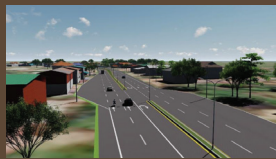
กรณีเกาะกลางแบบยก (Raised Median)
